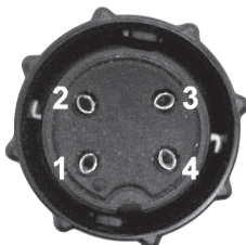
Figura 8 - Conector do Cabo de Alimentação.
